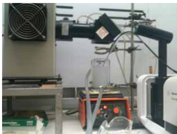
図 1. 光ファイバークラップアクセサリを設置した Cary 60 UV-Vis を使えば、サンプルの in situ 測定や装置から離れたサンプルの測定が容易になります。
