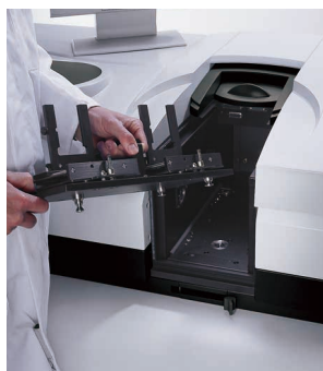
1. サンプルコンパートメントにアクセサリを挿入
