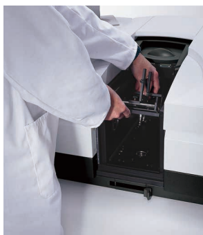
2. 取り付け用の穴の上にアクセサリを配置
