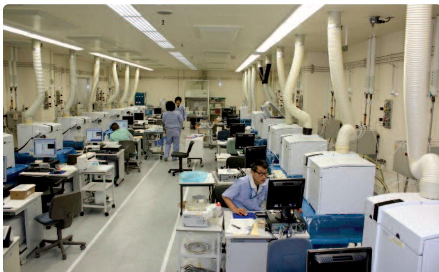
図1. Agilent 7700 シリーズ ICP-MS の最終テストライン
