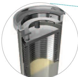
イオンビーム集光 (IBC) テクノロジー (特許出願中) は、イオンビームを最大 10 倍集光および冷却します。これにより、イオン損失が減少し、質量割り当ての精度が向上します。**質量分解能と質量精度は、最大 200% 向上します。**
