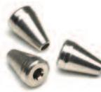
アジレントのベスベル/グラファイトフェラルは、破損して検出器を汚染することがあるグラファイトのフェラルとは異なり、GC/MS アプリケーションに理想的な硬度を持っています。新しいカラムを取り付けるときにはすべてのフェラルを交換するようにしてください。
