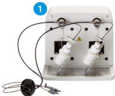
マルチモードでの検出やイメージングを行う多数のアプリケーションにおいて、分注直後の反応を測定または撮影する機能は有用です。アジレントは、このような素早い反応を容易に自動化するために、デュアル試薬インジェクターモジュールを提供しています。
