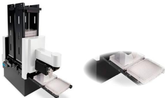
Agilent BioTek BioStack マイクロプレートスタッカーは、コンパクトでありながら優れた汎用性を備え、Agilent BioTek のウォッシャー、ディスペンサー、プレートリーダー、およびイメージングシステムと組み合わせて使用できます。
