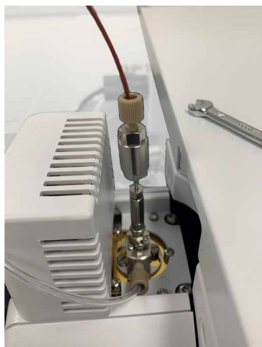
図 1 : ZORBAX Extend-C18、80 Å、2.1 mm、1.8 µm、120 MPa の圧力上限、UHPLC ガードカラムをネブライザに直接付加して、サンプルがクロマトグラフィーカラムを通過する状態をシミュレートしました。
