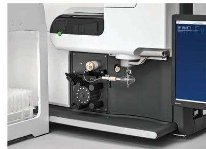
4210 MP-AES に取り付けられたアドバンスドバルブシステムの 4 ポートスイッチングバルブ (AVS 4)
