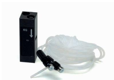
蛍光フローセル、40 µL、10 mm 光路長、M6 ネジ式コネクタ付きのインレット/アウトレット PTFE チューブ (外径 1.6 mm) が付属、6610023700
