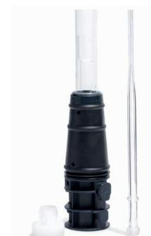
Easy-fit フルデマンタブルトーチ、内径 0.8 mm 石英インジェクタ、揮発性溶媒用、G8020-68001
