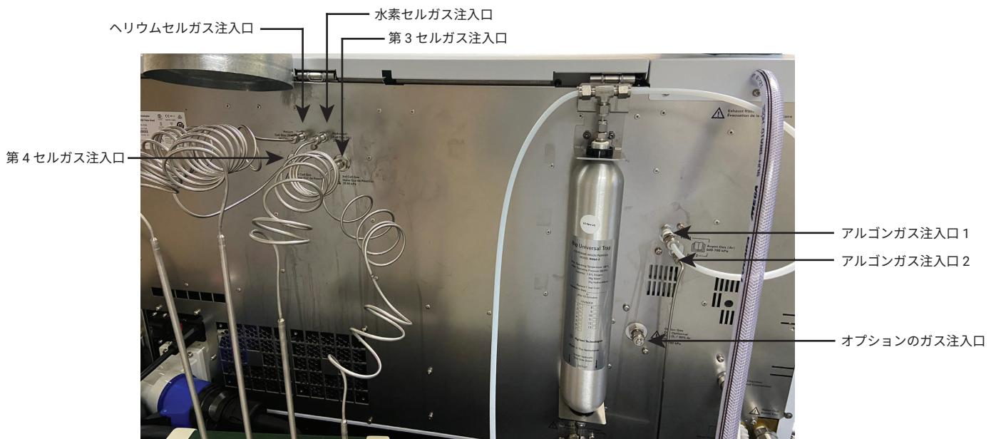
図 17. Agilent ICP-MS の背面図。Agilent CrossLab CS リークディテクタでチェックする必要のあるガス注入口
