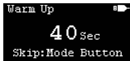
図 5. Agilent CrossLab CS リークディテクタのウォームアップ画面
