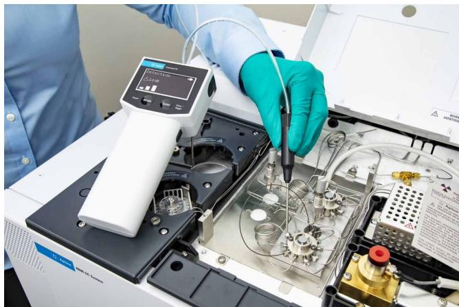
図 6. Agilent CrossLab CS リークディテクタを使用したバルブシステムのリークチェックの例。
