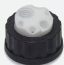
5043-1220 GL45 キャップ、4 ポート、 リークホース x 1、フィッティング x 4 : 3.2 mm (2)、 2.3 mm (1)、1.6 mm (1)
