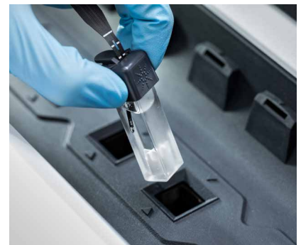
図 7. Agilent Cary 3500 UV-Vis 独自のキュベット内温度プローブには、超高速フィードバックループが付いています。このプローブでは、サンプルから直接、即座に温度を測定できます。
