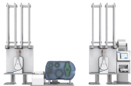
BenchCel Workstation (左：バーコード発行・貼り付け、右：プレートシール)
