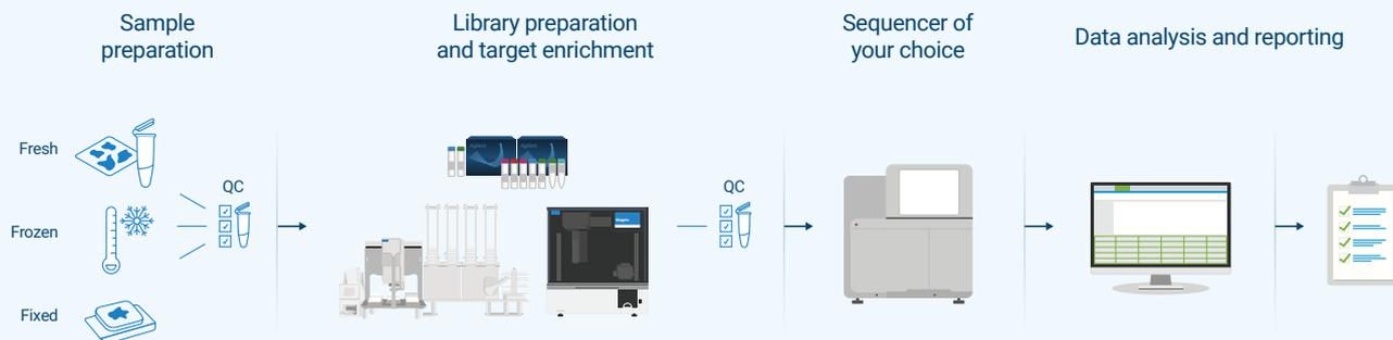
フレキシブルで効率的なワークフローにより、複雑性の高い NGS ライブラリを調製します。自動化されたライブラリ調製およびターゲットエンリッチメントにより、核酸サンプル QC を実施してから 4 日足らずでシーケンシングの結果を得られます。Illumina、Element Biosciences、Pacific Biosciences、MGI などのさまざまな対応シーケンサに合わせて、サンプルスループットを設定します。ラボに最適なデータ解析およびアノテーションソリューションを使用して、臨床的に重要なバリエーションを評価します。
