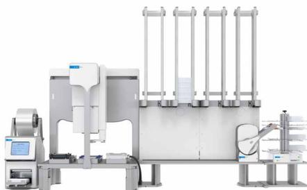
**Bravo NGS Workstation** はスループットを向上させるための分注プラットフォームです。再現性と品質を維持しながら、最大 96 個のライブラリを同時にスケールアップして調製できます。このオープン自動化プラットフォームでは、開発中の他のアッセイを調整および最適化するためのアプリケーションにおいてユーザーに柔軟性を提供します。
