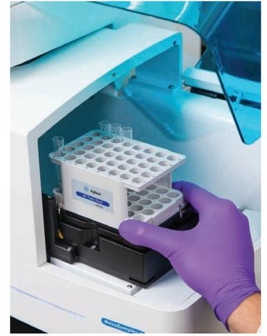
NovoSampler Q はさまざまな自動化プラットフォームとの統合に対応しており、FACS チューブ（40 本チューブラックを使用）も、24、48、96、384 ウェルプレートも効率的に処理できます。
