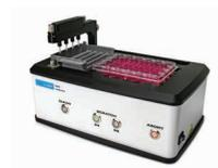
Agilent BioTek Autoscratch により、スクラッチ創傷を自動的に作成
