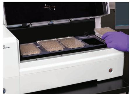
Agilent BioTek LogPhase 600 微生物用プレートリーダーは一度に最大 4 枚のマイクロプレートを測定できます。微生物の増殖アッセイで、複数の装置や PC、そのための広いスペースなどは不要になります。
