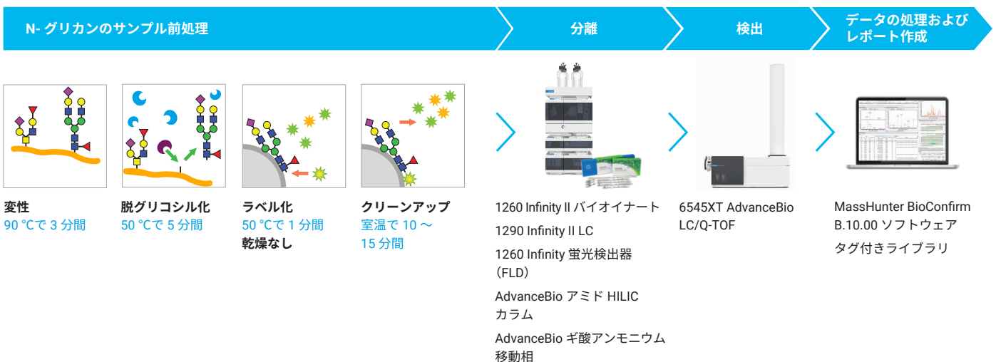
図 1. Gly-X InstantPC サンプル前処理と LC/FLD/MS を用いた遊離 N-グリカン分析のワークフロー
