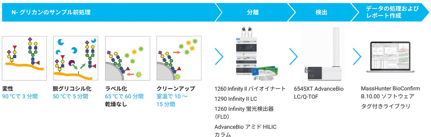
図 1. Gly-X 2-AB Express サンプル前処理と LC/FLD/MS を用いた遊離 N-グリカンの分析ワークフロー
