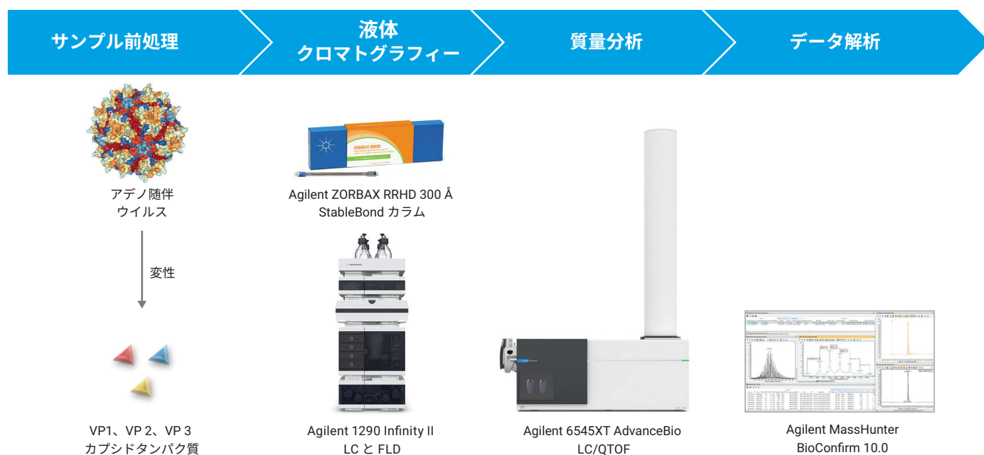
図 1. インタクト AAV カプシドに含まれる個々のカプシドタンパク質の同定を確認して相対量を測定するプロセスの概要
