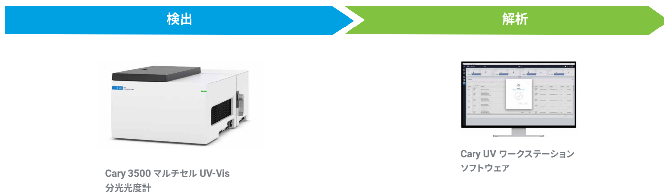
図 11 : UV-Vis 分析による最終製品の QC のワークフローソリューション
