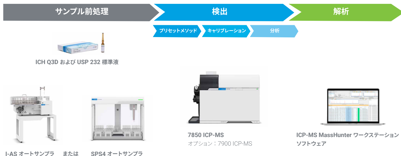
図 12：ICP-MS による微量元素不純物分析のワークフローソリューション
