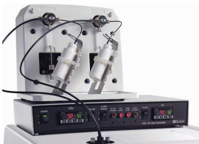
生細胞アッセイに適した CO<sub>2</sub> および O<sub>2</sub> 濃度を維持できるように制御する、コンパクトなガスコントローラーです。このガスコントローラーは、Lionheart FX および Cytation システムで使用できます。
