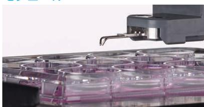
Lionheart FX および Cytation のデュアル試薬インジェクターモジュールにより、高速な細胞反応のイメージングや検出が可能です。
