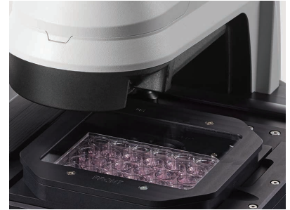
Agilent BioTek Lionheart FX 全自動顕微鏡に取り付けられた湿度チャンバ
