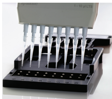
図 1. Agilent BioTek Synergy LX マルチモードプレートリーダーは、Agilent BioTek Take3 微量サンプル測定プレートに対応しています。
