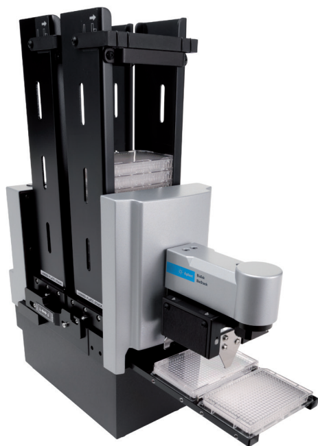
図 5. Agilent BioTek MultiFlo FX は、Agilent BioTek BioStack マイクロプレートスタッカーと一体で、最大 50 枚のプレートを手動処理します。
