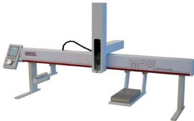
Gerstel社 多機能オートサンプラ MPS2
