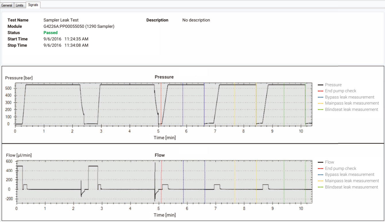
図 11. Agilent Lab Advisor のサンブラリークテストでは、ロータシール、計量デバイス、ニードルシート、システムで特定のリークレートを検査します。テストでは、インジェクションバルブのポート 6 (アウトレット) にプランクナットを取り付ける必要があります。最初に選択したチャンネルでポンプヘッドのリークテストを実施し、次にバイパスポジションで、その次にメインパスポジションで圧力テストを行ってから、最後に、ブロックされたシートポジションにニードルを設置した状態でメインパスポジションにて圧力テストを実施します。テストの最後に、結果が自動で評価されます。
