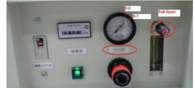
圧力: **0.65MPa** (規定値 **0.6~0.7MPa**)、フローバルブ **フル Open** 確認
