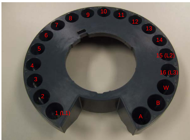
150 サンプルトレイが接続されていない時のインジェクタのターレット (16 バイアルターレット)
