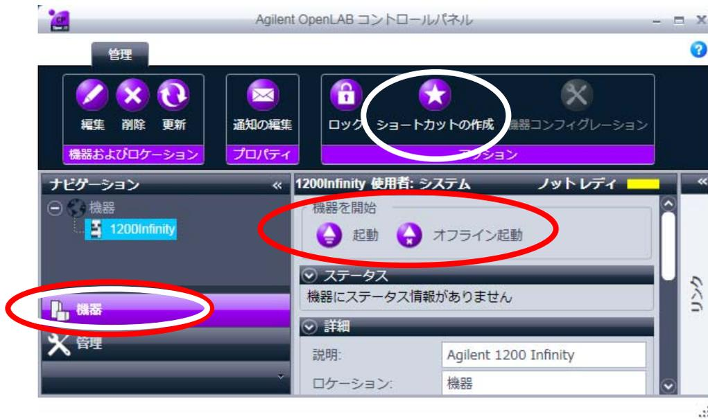
機器を構成するには、ロケーション（Lab\_01 など）を作成し、そのロケーションに機器を作成します。機器の名前（HPLC\_01 など）と機器タイプ（Agilent LC System）等を設定すると、ロケーションに機器が作成されます。この機器を選択して、上部リボンの機器コンフィグレーションで、機器の構成を選択します。
