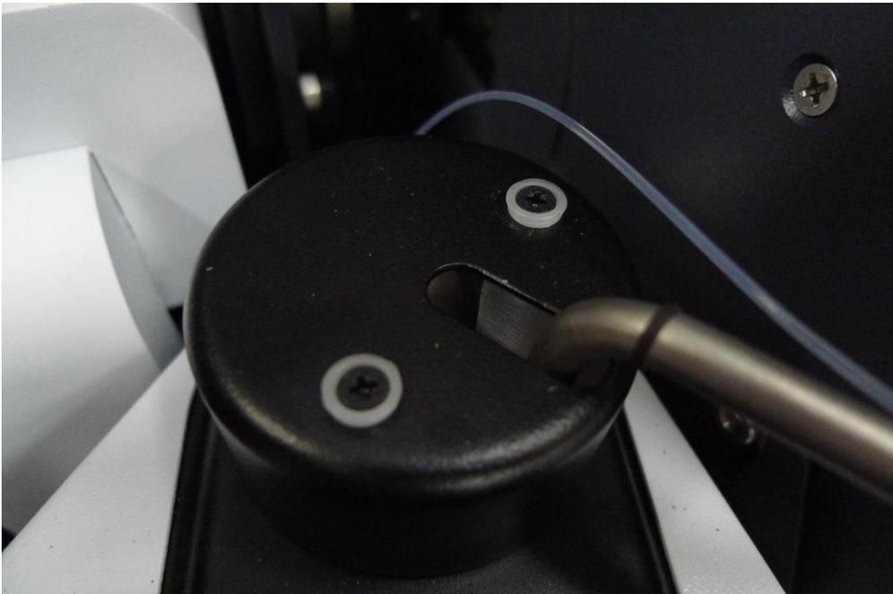
2.カバープローブを上方方向にスライドさせ、アームを装置奥側へと倒します。
