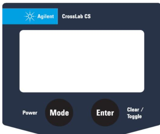
図 1 Agilent CrossLab CS リークディテクタの操作ボタン
