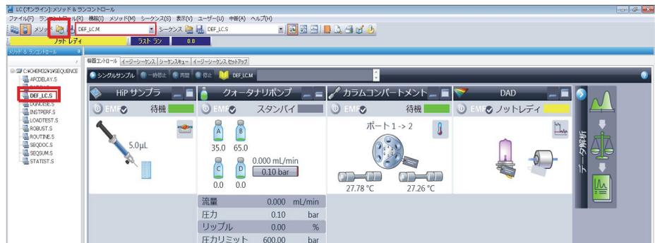
デフォルトのメソッド (DEF\_LC.M) は、一連のデフォルトパラメータを持っており、これらを変更することによって新しいメソッドを作成します。たとえば、流量にゼロを設定し、**メソッド情報** と **メソッド履歴** をブランクにします。
