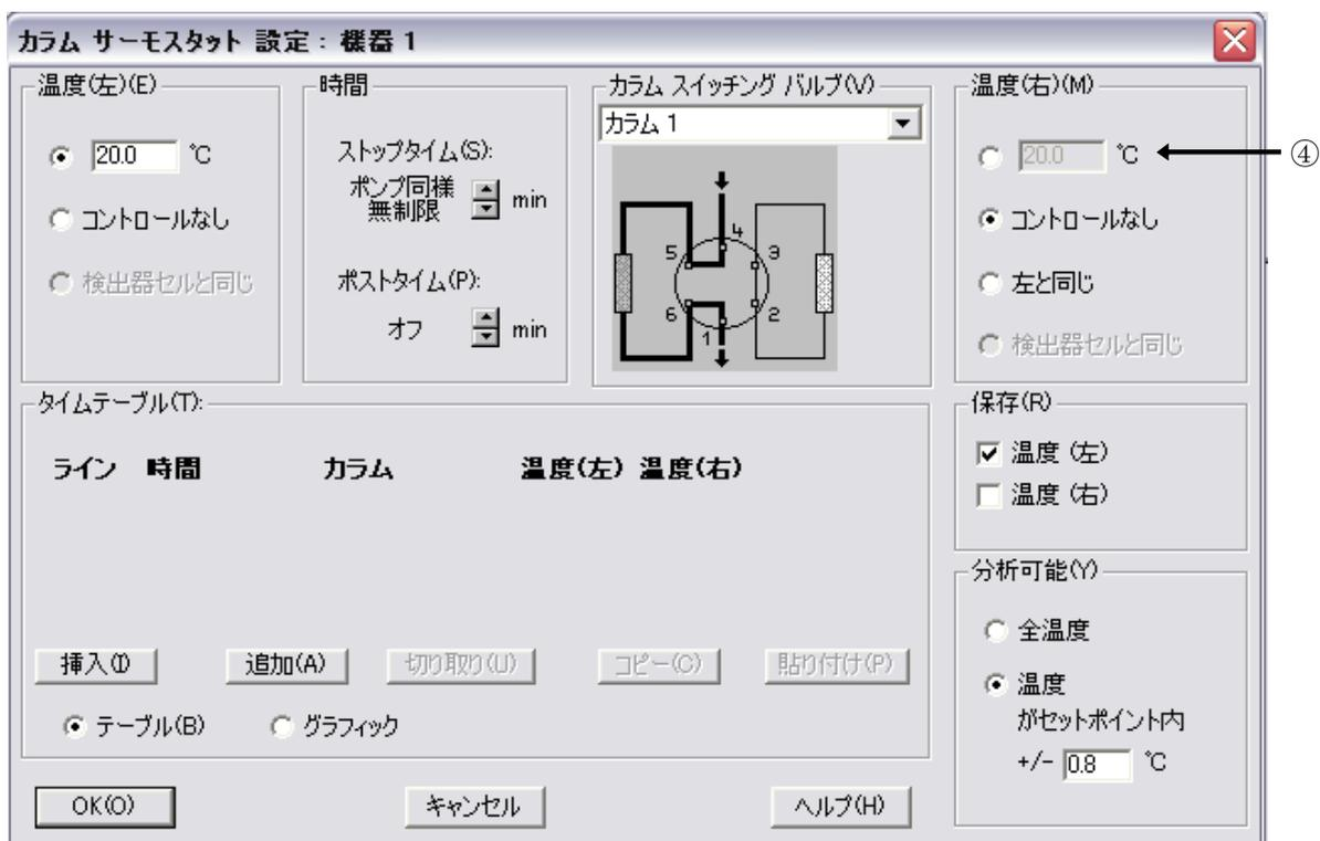
④ 右のヒーターブロックの制御方法を選択します。
