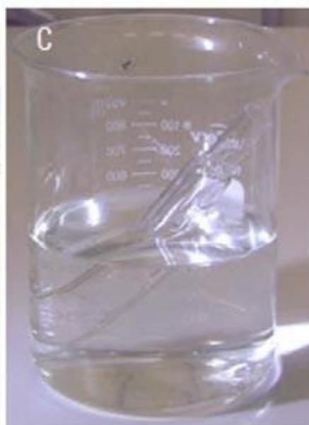
3. 浸漬後、以下の写真に示すように、洗浄びんでトーチの内側および外側に脱イオン水 (18 MΩ.cm) で十分に洗い流します。洗浄水が石英製チューブを通してガス入口およびボールジョイントコネクタから流れ出るように、30 秒以上すすいでください。
