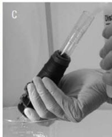
4. 3つのガス供給口 (ベース部の2箇所およびボールジョイントコネクタ) からきれいな圧縮空気または窒素を吹き付けて水分を飛ばし、トーチを乾かします。水分を完全に除去してください。
