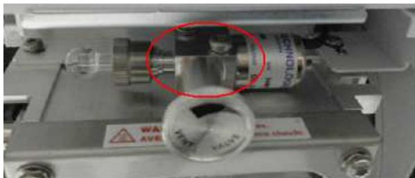
漏れていた場合、MS を停止して大気開放後に内部 O リングを清掃するか交換します。
