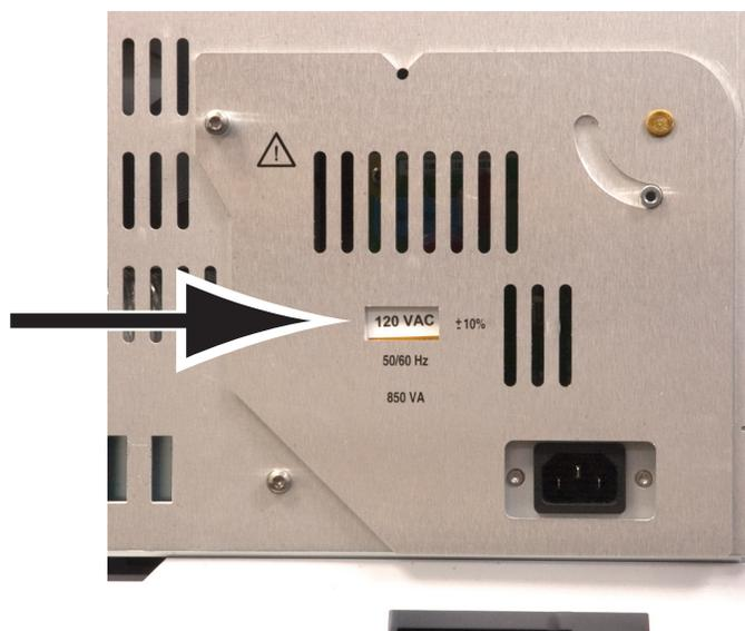
表示されている電源コンフィグレーションが、使用可能な主電源電圧と一致しない場合は、**Agilent** までお問い合わせください。適切な電圧コンフィグレーションプラグと電源コードを入手する必要があります。詳細については、『[据付](#)』マニュアルおよび『[サイト準備](#)』ガイドを参照してください。
