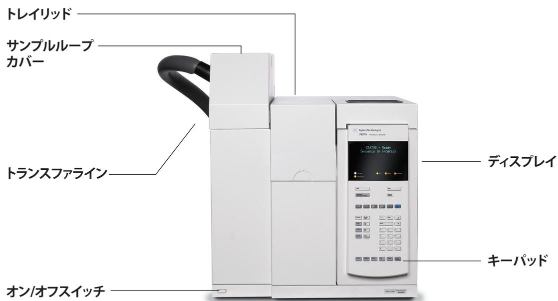
図2 12 バイアルモデル - 前面
