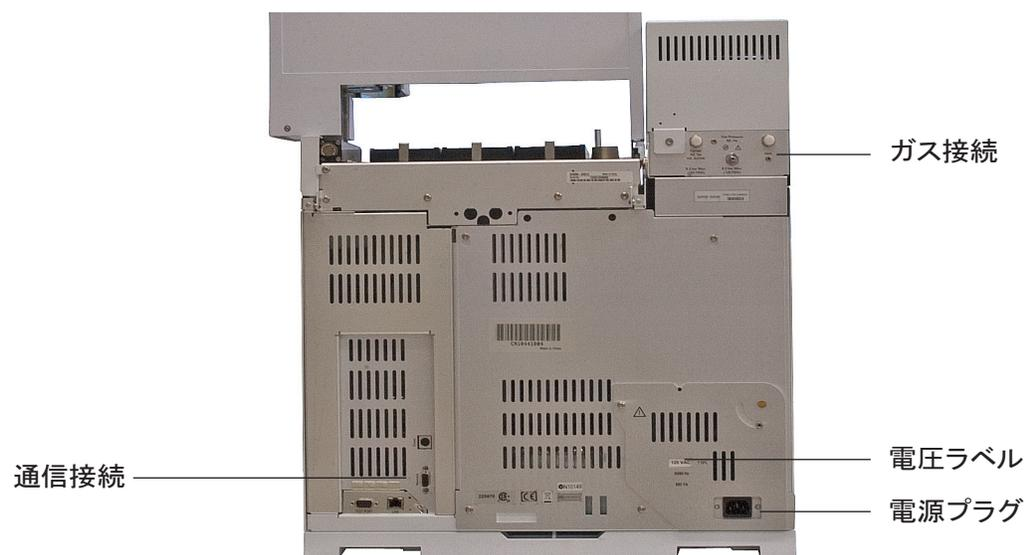
図3 12 バイアルモデル - 背面 (111 バイアルモデルも同様)
