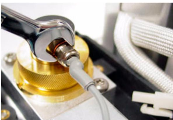
c ナットを手で反時計回りに回します。イグナイタと銅製ワッシャを取り外します。
