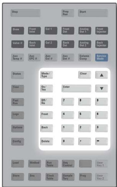
**[Mode/Type]** 数値以外の設定に関連したパラメータのリストにアクセスします。たとえば、GCでスプリット/スプリットレス注入口をコンフィグレーションし、**[Mode/Type]** キーを押すと、スプリット、スプリットレス、パルスドスプリット、およびパルスドスプリットレスが表示されます。
