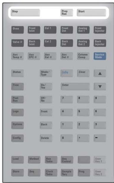
**[Prep Run]** プレランキー。メソッドで指定されている開始条件に GC をセットするためのプロセスを開始します（スプリットレス注入時に注入口パージラインを閉じたり、ガスセーバーモードから通常流量に戻したりなど）。詳細については、『[アドバンスド操作マニュアル（英語）](#)』を参照してください。
