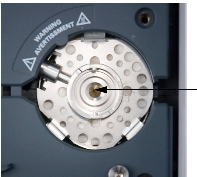
6 シールの表面に汚染がないか確認します。必要に応じて、綿棒を使用してクリーニングします。
