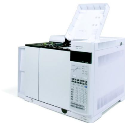
GC を設置台に置き、検出器のカバーの下にある検出器のキャップを取り外します。
