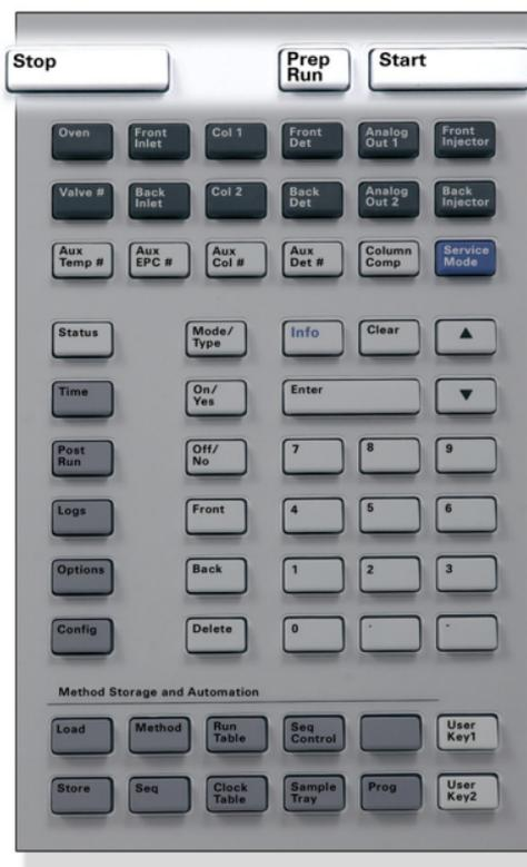
**[Stop]** ただちに分析を終了します。GC が分析の途中の場合は、その分析のデータが消失することがあります。**[Stop]** を押した後再度分析を行う方法については、『[Agilent 7890A GC Advanced User Guide](#)』を参照してください。
