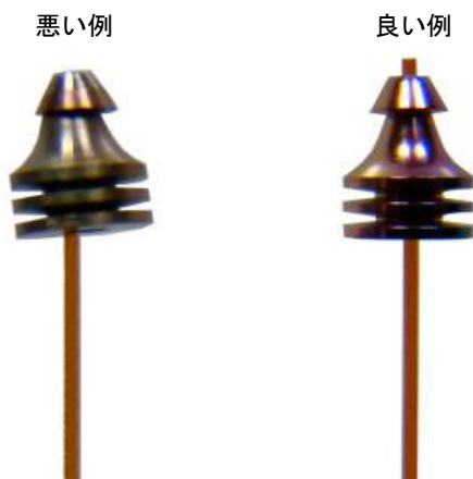
Figure 7 固定されたフェラルの例
