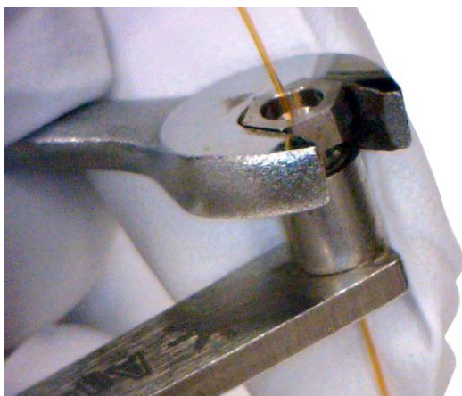
Figure 4 内部ナットの締め付け
