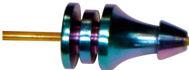
Figure 6 適切にトリミングされたカラムとフェラル
