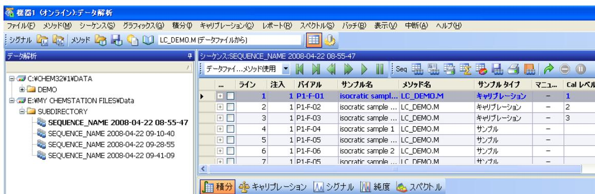
図 6 ChemStation エクスプローラからナビゲーションテーブルへのシーケンスの読み込み
