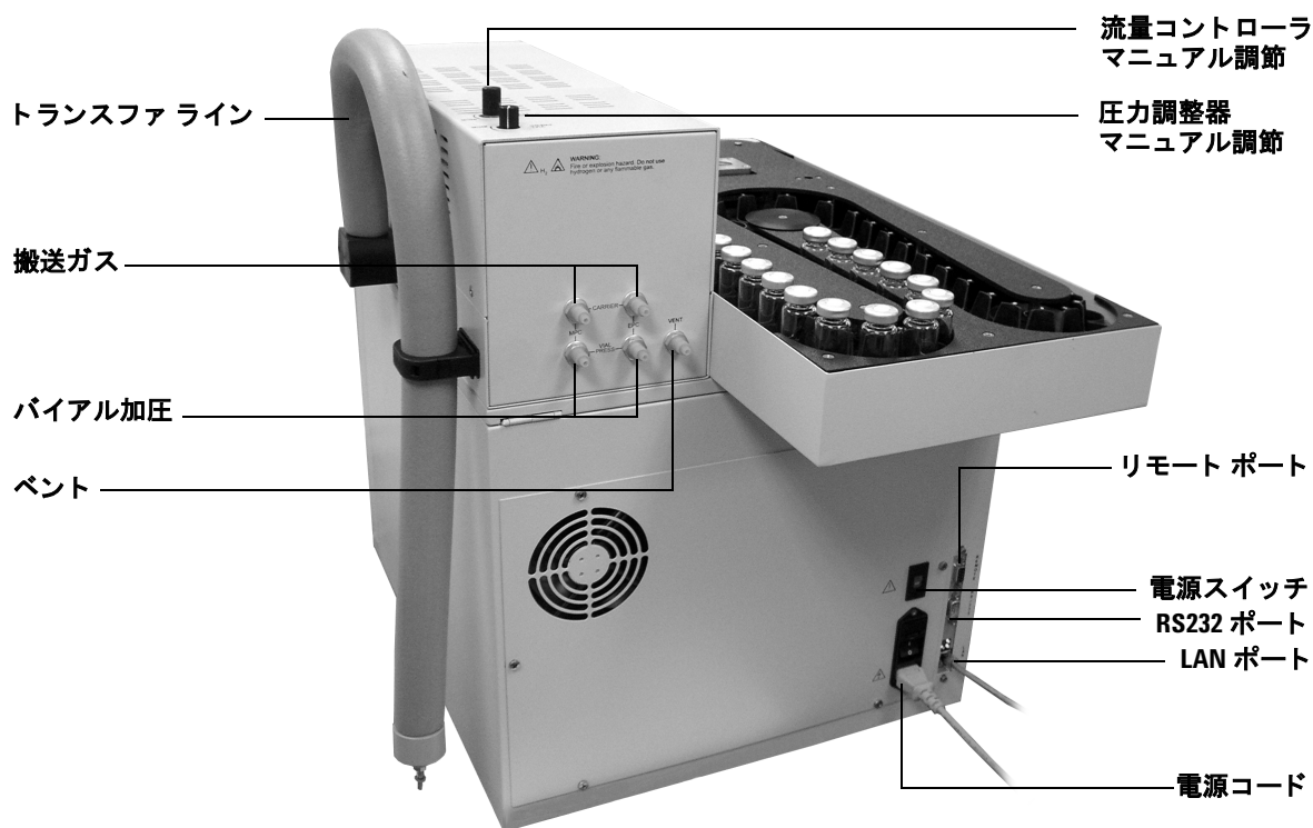
図 2 G1888 NetworkHeadspace Sampler の外観 (後面)
