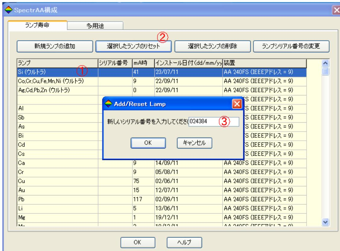
新しい HC ランプに交換される場合は、[選択したランプのリセット]ではなく、[選択したランプの削除]をクリックしてください。対象ランプの行が削除されます。新しい HC ランプを使用すると、自動的に新しいランプの行が追加されます。
