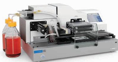
ペリスタルティックポンプとデュアルシリンジポンプが 1 つずつ取り付けられた Agilent BioTek 406 FX ウォッシャー・ディスペンサー
