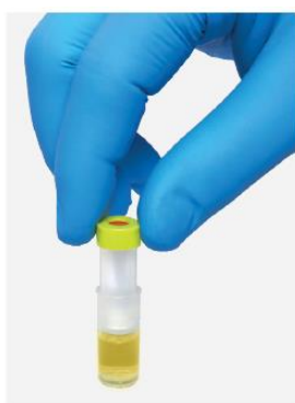
2. キャップ フィルタ付きキャップを 差し込みます。
