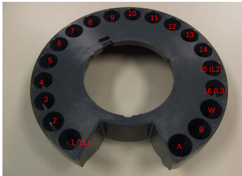
150 トレイなしのインジェクタのターレット（16 バイアルターレット）
