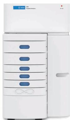
5400 Fragment Analyzer System は、96 キャピラリアレイを使用した超高スループットシステムです。試験済みの Application Program Interface (API) を使用しているロボティクスシステムの大半に完全統合できるよう設計されていて、1 日に 2400 サンプルを分析できます。
