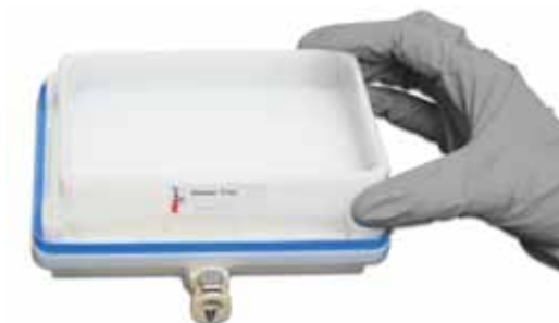
図 6. 廃液トレイが取り付けられた真空マニホールド
