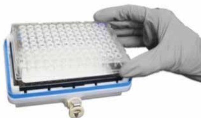
図 19. コレクションプレート (PCR プレート)
