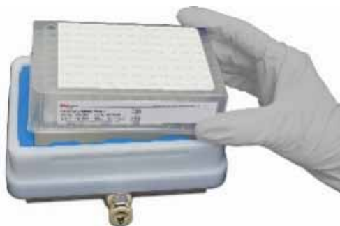
図 7. 廃液トレイとクリーンアッププレートが取り付けられた真空マニホールド
