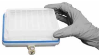
図 15. ロードプレート（ディープウェル）
