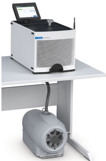
HLD BD15 ベンチリークディテクタに IDP-15 ドライスクロールポンプを接続
